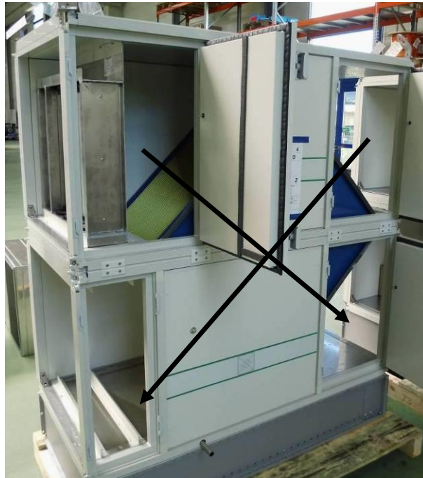
Foto 9: Wärmerückgewinnung mit Bypassklappe mit fortluftseitiger Kondensatwanne; fortluftseitiger Tropfenabscheider entnommen; Bedientüren / -paneele geöffnet / demontiert, die abgebildete Bypassklappe war nicht Bestandteil der Prüfung.
